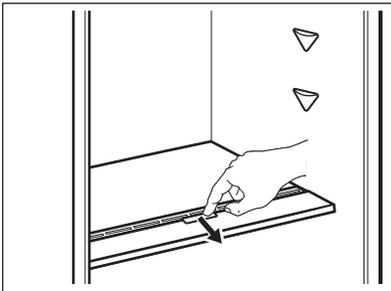
Pour retirer le dispositif de contrôle de l'humidité, ouvrez le bac sous l'étagère en verre et retirez le couvercle.
